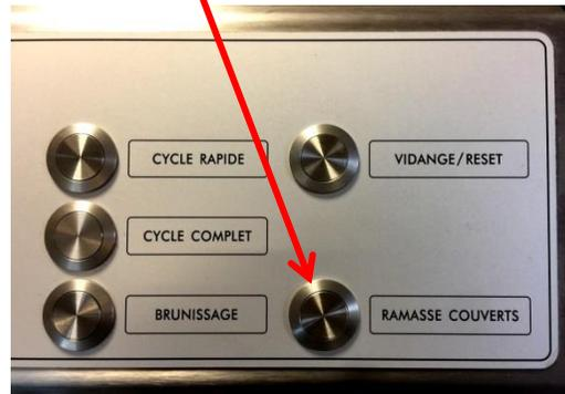
3 - Une fois le cycle « Ramasse couverts » terminé (voyant « FIN DE CYCLE » allumé), ouvrir le capot de l'appareil et remonter le panier via les 2 poignées.
