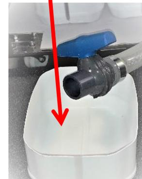
4 – Ouvrir la vanne du robinet ¼ tour pour récupérer les billes et repositionner le tuyau comme sur l'étape N°2 (TUYAU NON PINCÉ NI COUDÉ)
